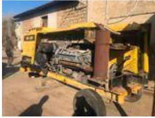
BLOC VIS COMPRESSEUR SUR CHASSIS DOOSAN ATLAS COPCO
